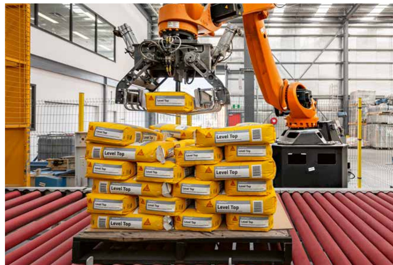
Roboter machen den abgepackten Mörtel für den Weitertransport bereit. Die vollautomatisierten Abläufe sorgen für geringere Betriebskosten.
